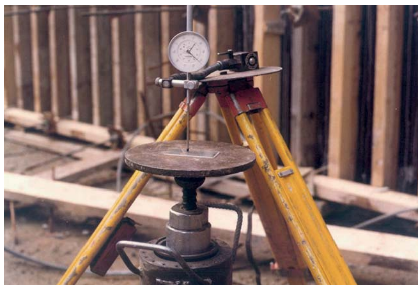
Figuur 6 Meetopstelling t.b.v. beproeving vertikaal anker
