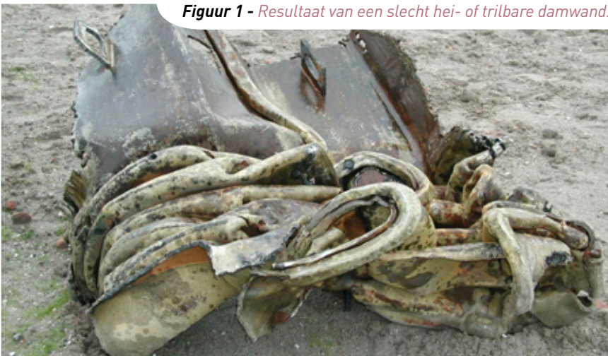
Figuur 1 - Resultaat van een slecht hei- of trilbare damwand.
